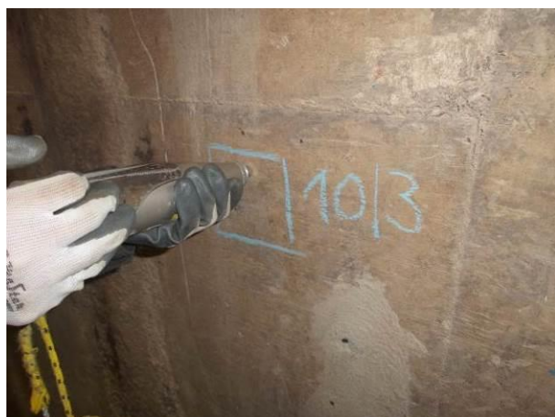
Fot. 4.1. Przykładowy widok na przebieg badań sklerometrycznych betonu
