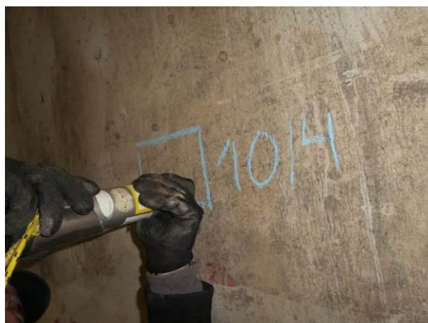
Fot. 4.1. Przykładowy widok na przebieg badań sklerometrycznych betonu
